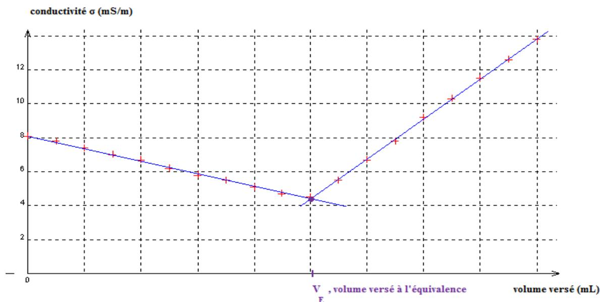
Le volume équivalent est l'abscisse du point d'intersection des deux droites. Pour tracer les deux droites, il faut passer par le maximum de points en en laissant autant au-dessus, qu'au-dessous. Le point d'intersection n'est pas nécessairement un point de mesure.
