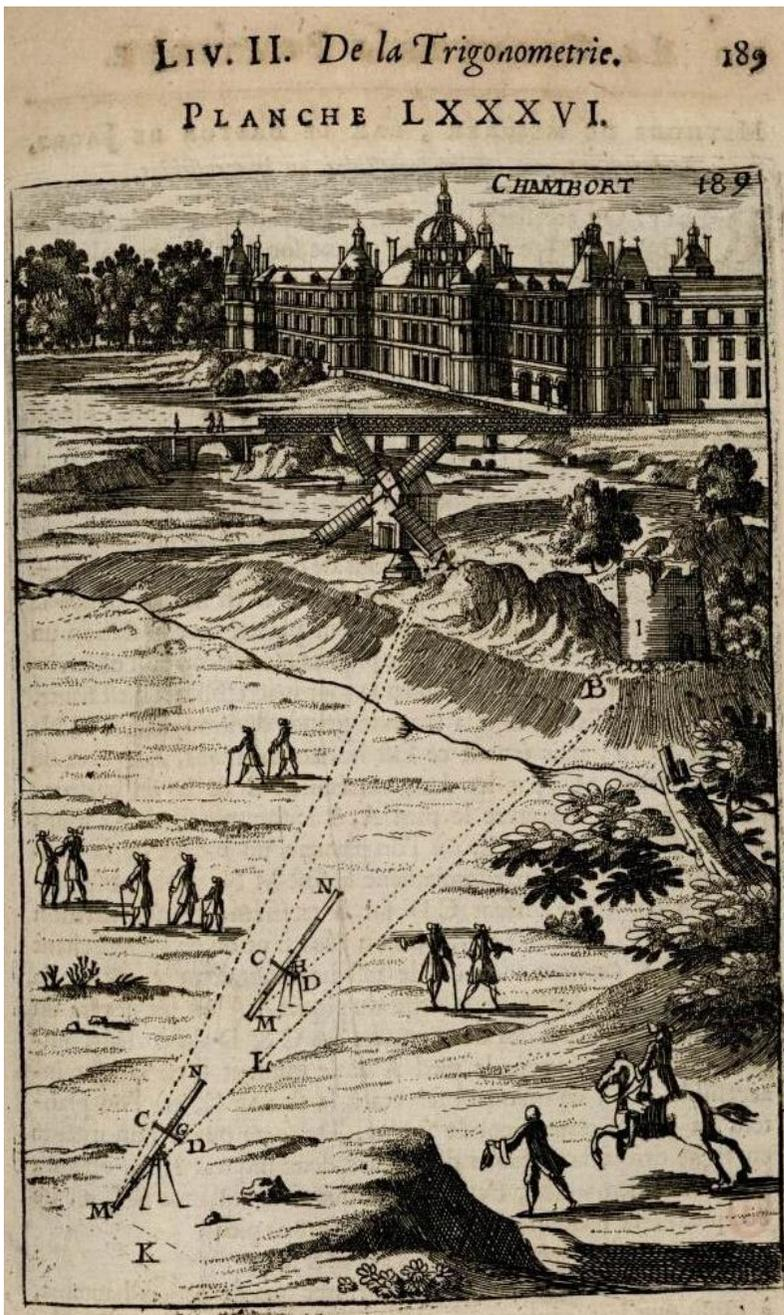
METHODE DE MESURER, PAR LE BASTON DE JACOB, les hauteurs, soit accessibles ou inaccessibles.
