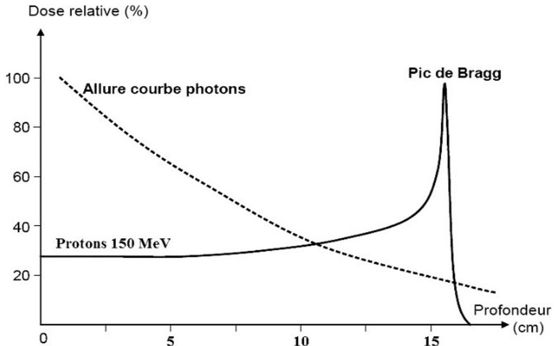
**Figure 2 : Énergie déposée dans un tissu en fonction de la profondeur de pénétration du faisceau.**
