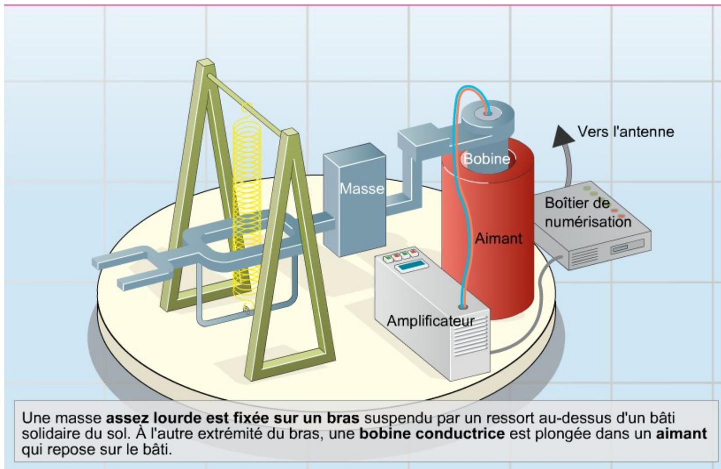
Une masse **assez lourde** est fixée sur un bras suspendu par un ressort au-dessus d'un bâti solidaire du sol. À l'autre extrémité du bras, une **bobine conductrice** est plongée dans un **aimant** qui repose sur le bâti.
